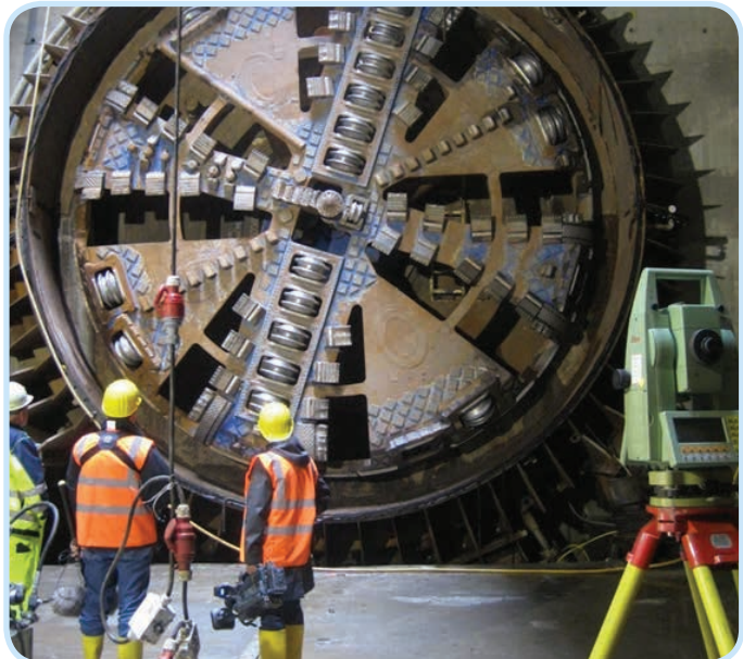
نمایی از کاترتی بی ام که تیغه‌های متفاوتی برای حفرتونل مورد استفاده قرارگرفته‌اند
