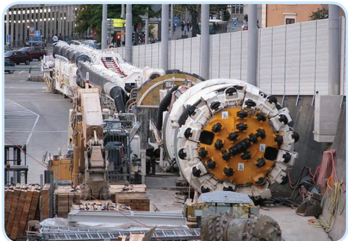
نمونه‌ای از یک دستگاه تی بی ام باز که معمولاً برای حفاری در سنگهای سخت ترو غیرریزشی استفاده می‌شود
