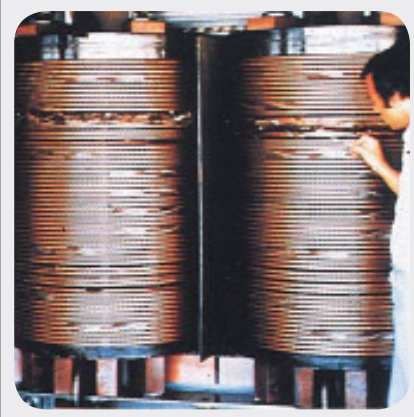
خسارت به سیم پیچ‌ها به علت اتصال کوتاه
